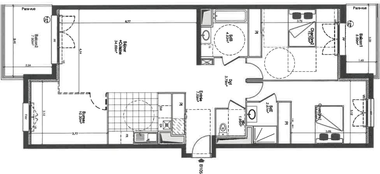
LEGENDE: PF: Paroi Fenêtrée / F: Fenêtre / FAV: Fenêtre Allège Vitée / VR: Votet Roulant / GVL: Cadre Technique du Logement / PI: Placard / CUL: Cuisine / RR: Réfrigérateur / LL: Lave Linge / LV: Lave Vaisselle / CH: Chaudière / Soffite, faux plafond / HSP: 2.30
